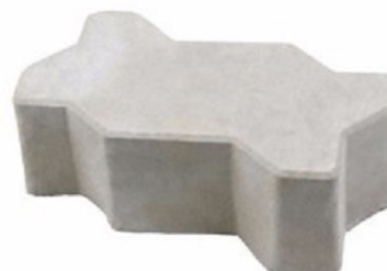
Figura 2 – Bloco de concreto 16 faces com espessura de 8cm e resistência mínima de 35MPa.
