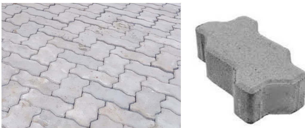
Figura 3 – Bloco sextavado de concreto com espessura de 8cm e resistência mínima de 35MPa.
